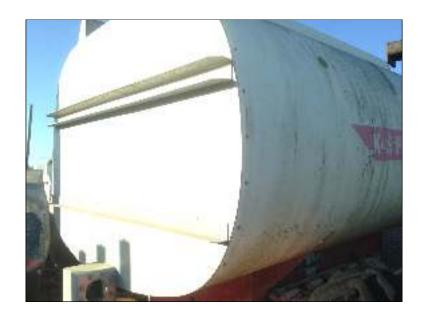
ALLOY FUEL TANKS WITH STEEL ENDS
